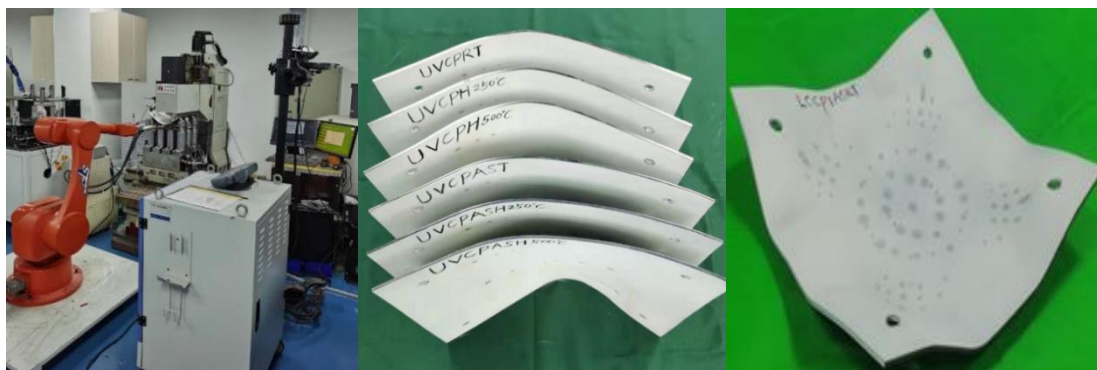
图1. 电磁感应辅助加热无模渐进弯曲成形工艺设备及成形试样
